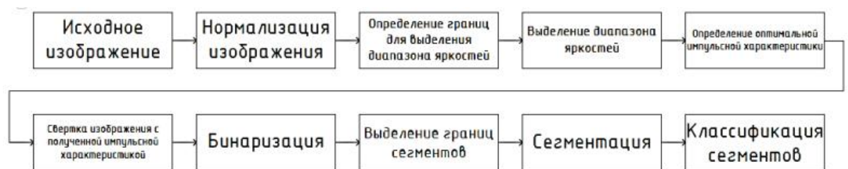
Рис. 1. Структурная схема алгоритма обработки радиолокационных спектрограмм сигналов, отражённых от объектов.
